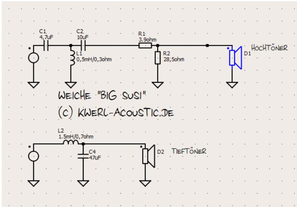
Die Weiche ist einfach aufgebaut, im Hochtonbereich empfiehlt es sich, zwei MKP Kondensatoren und eine Luftspule zu verwenden. Im Bassbereich kann auch eine Kernspule zum Einsatz kommen. Hochtöner und Tieftöner werden nicht verpolt.
